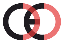
Marcatura CE contraffatta (troppo vicino)
